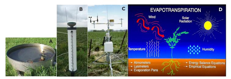
Figure 1: (a) Evaporation Pan, (b) Atmometer, (c) ET Weather Station, (d) ET Measurement Methods
